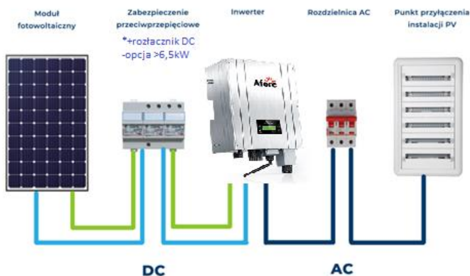
Rys.1 Schemat poglądowy instalacji fotowoltaicznej
